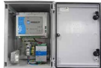
**Unità di controllo** preassemblata in un quadro in poliestere. È costituita da una scheda elettronica di controllo, un alimentatore su barra DIN, un pacco-batteria tampone, un contatto tamper e un rivelatore sismico per la protezione antiscasso e antisfondamento del contenitore.
