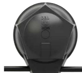
**Sensore a rivelazione puntuale** che integra un trasduttore piezodinamico e un'unità elettronica di analisi dei segnali. È fornito in linee-sensori precablate da 25, 10 o 5 rivelatori con passo standard di 3 metri.
