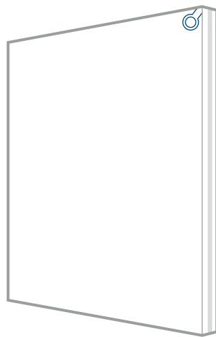
Alarmscheibe mit Alarmschleife (AS)
