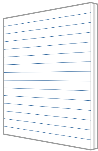
Alarmscheibe mit Alarmdraht (AD)
