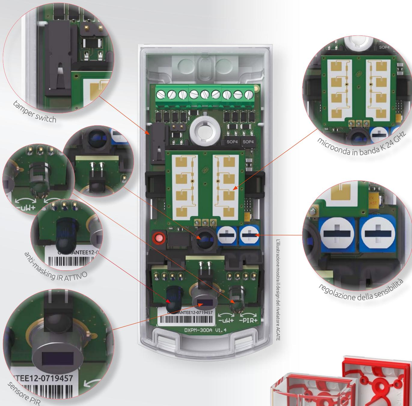
La custodia dei rivelatori è costituita da una combinazione di policarbonato ed elastomero termoplastico con tecnologia ad iniezione bicomponente. Il grado di protezione ottenuto è IP54, che li rende adatti per applicazioni all'aperto.
