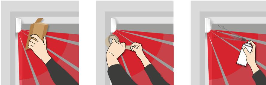
Secondo la norma EN 50131-2-4, la funzione di anti-mascheramento attivo di **AGATE** è implementata nel sensore ad infrarossi, che fornisce una protezione avanzata contro:
